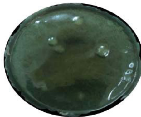
Рис. 4. Фотография исследуемой мембраны на основе [\text{Ag}(\text{Амох})_2]\text{ДМДСА} , модифицированной нанотрубками полианилина ( C_{ЭАВ}=2\% ) Fig. 4. Photo of the investigated membrane based on [\text{Ag}(\text{Амох})_2]\text{DMDSA} modified polyaniline nanotubes ( C_{EAS}=2\% )
