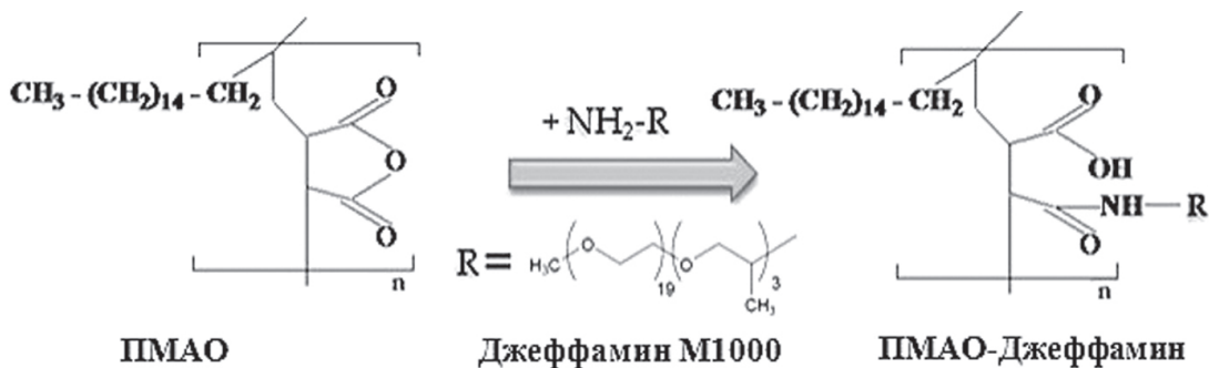
Рис. 5. Схема синтеза амфифильного полимера
