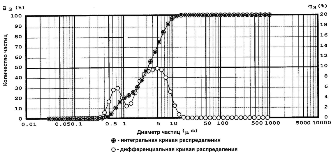
Рис. 1. Количественное распределение частиц образца 1 по размерам, мкм
