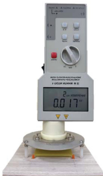
Рис. 2. Процесс измерения потенциала поверхности \phi Fig. 2. Surface potential measurement process \phi
