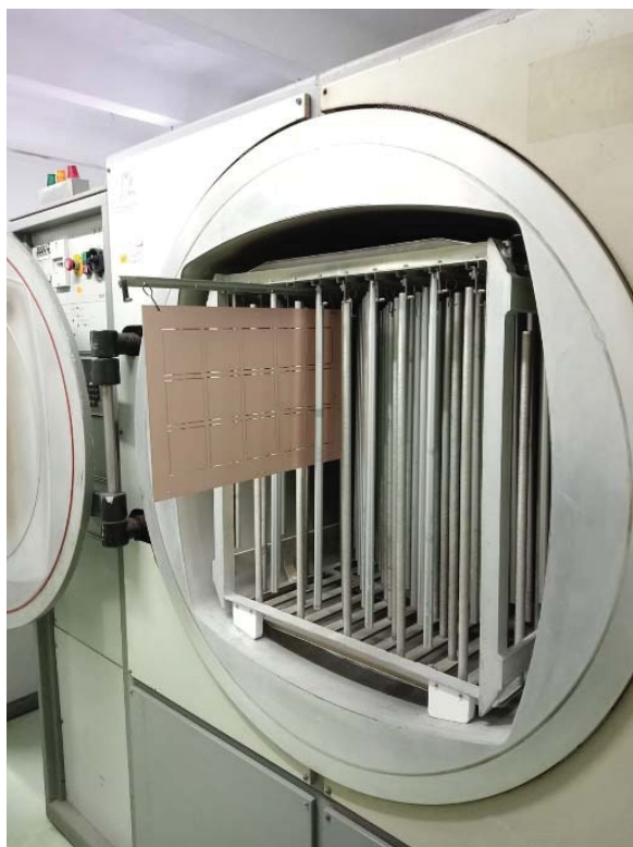
Рис. 1. Заготовка с образцами перед её помещением в рабочую камеру установки «Tepla 3027-E»
