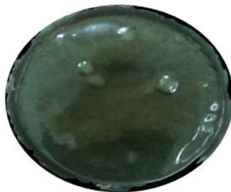
Рис. 4. Фотография исследуемой мембраны на основе [\text{Ag}(\text{Амох})_2]\text{ДМДСА} , модифицированной нанотрубками полианилина ( C_{\text{ЭАВ}}=2\% )
